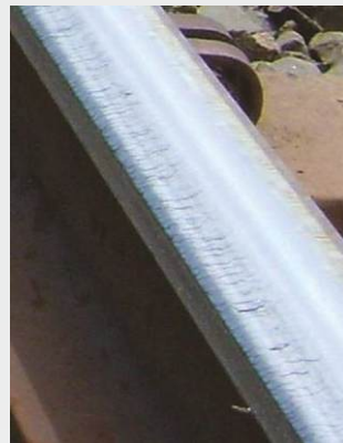
Vady head check na temeni kolejnice a jejich zobrazení pomocí softwaru
