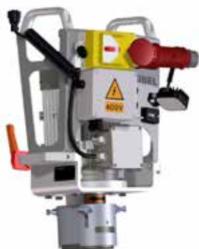
Modul hrncového brusného kotouče, elektromotor
