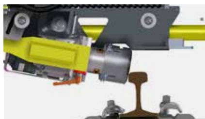
Modul hrncového brusného kotouče, elektromotor
