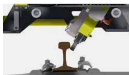
Modul brusného kotouče, elektromotor
