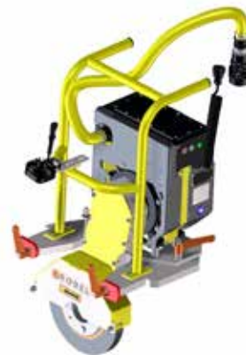
E 3 - Modul talířového kotouče, bezkartáčový stsm. elektromotor
