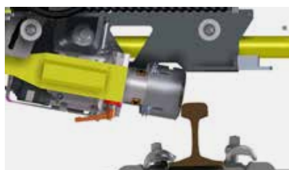
Maximální rozsah náklonu: 32° ven a 80° dovnitř
