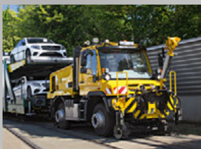
UNIMOG Posunovací kapacita až 1000 t
