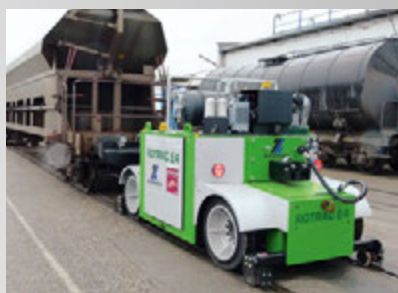
ROTRAC E4 Posunovací kapacita až 500 t
